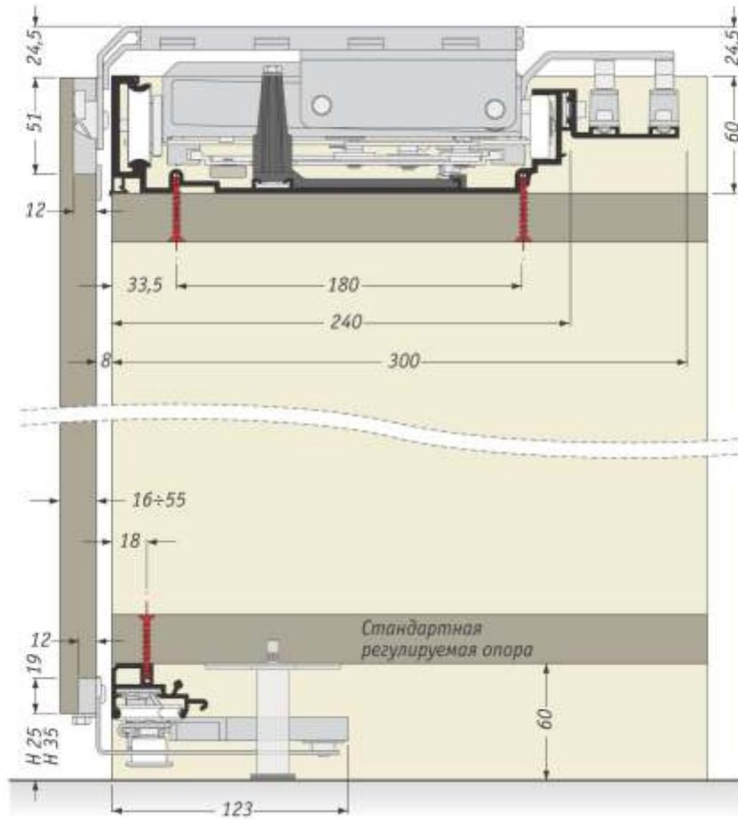
СХЕМА РАСЧЕТА ШИРИНЫ ДВЕРЕЙ ДВУХДВЕРНОГО РЕШЕНИЯ ДЛЯ КОМПЛАНАРНОЙ СИСТЕМЫ PS40, CINETTO
