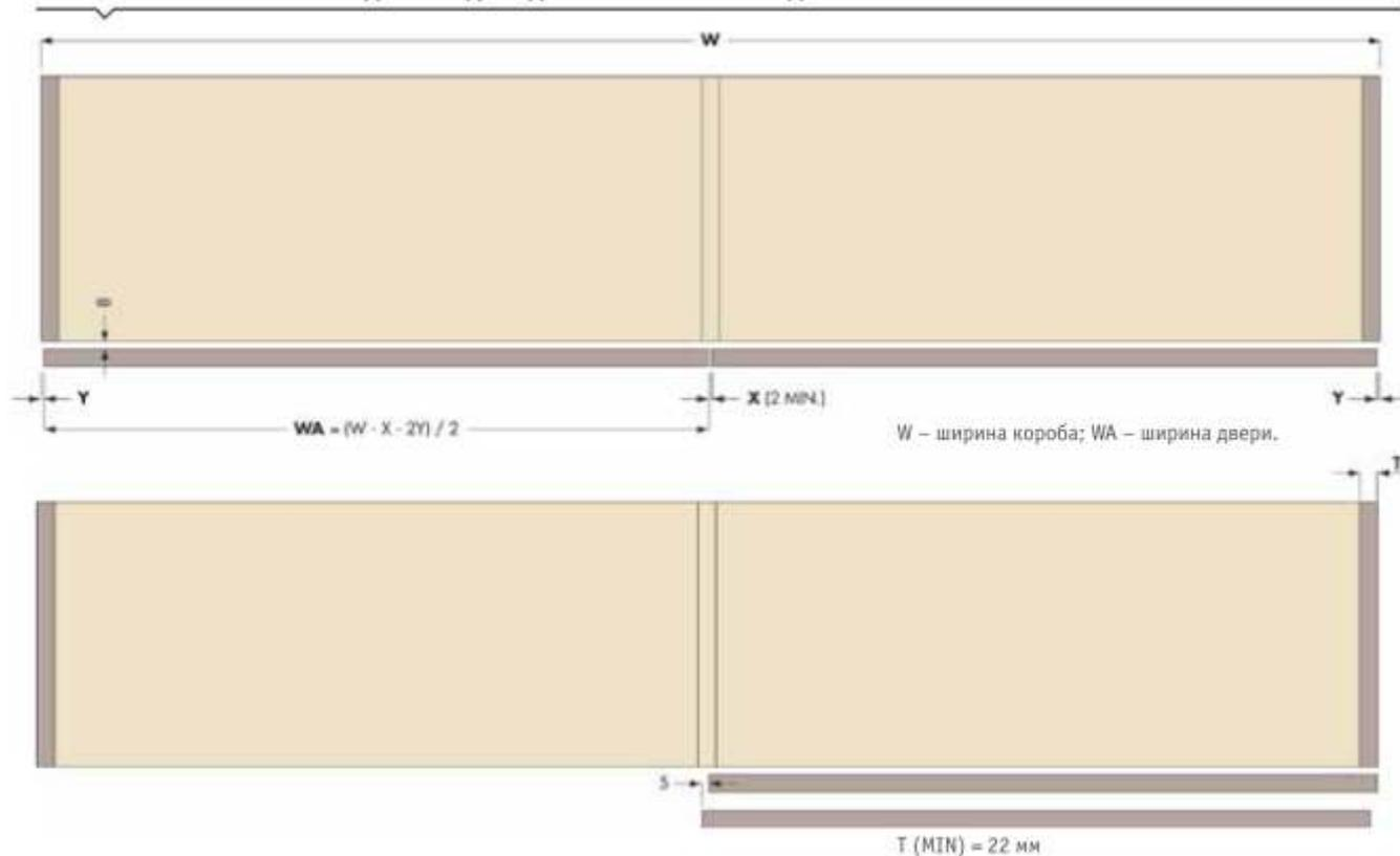
Схема сверления и фрезеровки отверстий на фасадах
