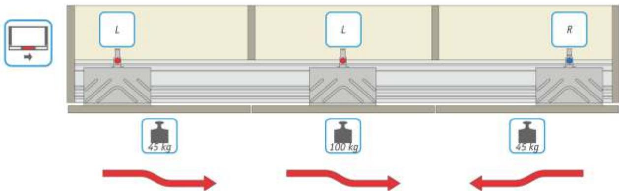
СХЕМА РАСЧЕТА ШИРИНЫ ДВЕРЕЙ ТРЕХДВЕРНОГО РЕШЕНИЯ ДЛЯ КОМПЛАНАРНОЙ СИСТЕМЫ PS40, CINETTO
